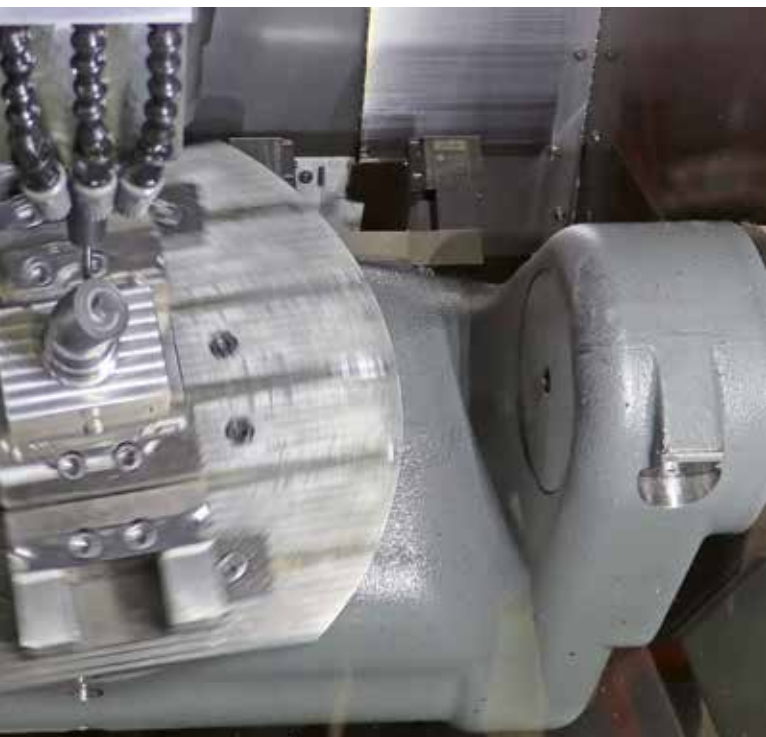
Durch die 5-Achs-Bearbeitung erzielt Biesinger Zeitvorteile und bessere Oberflächen – gerade auch bei komplexen Bauteilen wie diesem Krümmer.
